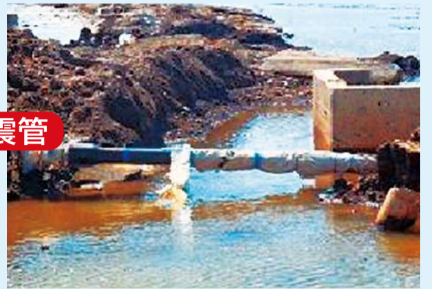
*写真は、東日本大地震で、継ぎ目が外れた従来管と津波にも耐えた耐震管(出典/宮城県企業局・仙台市水道局)
